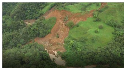
Se puede apreciar en estas imágenes la corona (en relleno de la carretera), el núcleo central o espinaza que prácticamente no se movió y el pie del deslizamiento.
