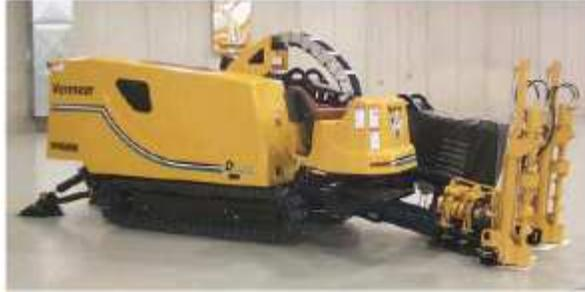
(Figura 1: Máquina de perforación horizontal dirigida, tomada de Manual de perforación horizontal dirigida, fuente, Vermeer Manufacturing Company, 2005)
