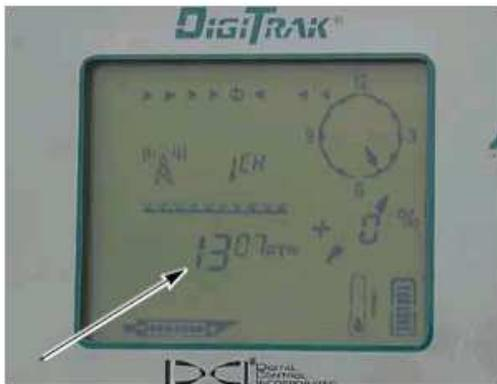
(Figura 14: Despliegue de la profundidad del localizador, tomada de Manual de perforación horizontal dirigida, fuente, Vermeer Manufacturing Company, 2005)
