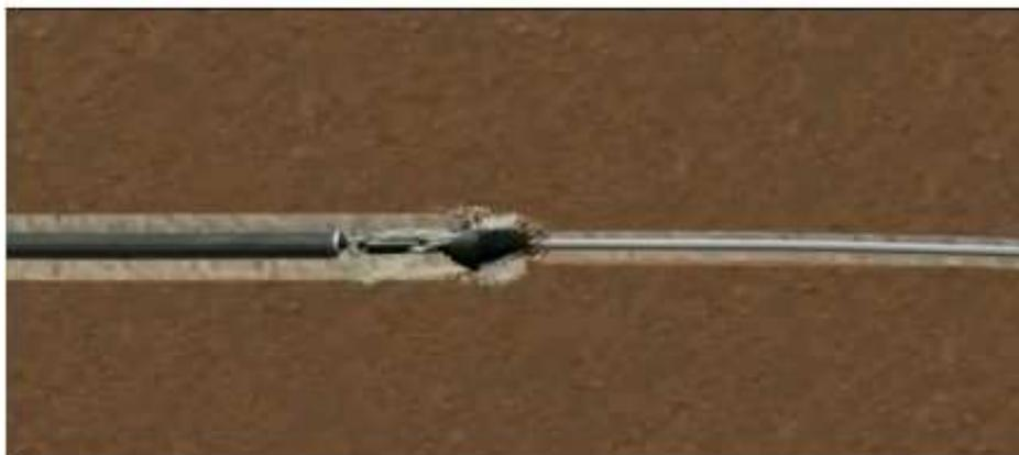
(Figura 9: Ampliación del ducto, fuente, VE group trenchless tec, 2011)
