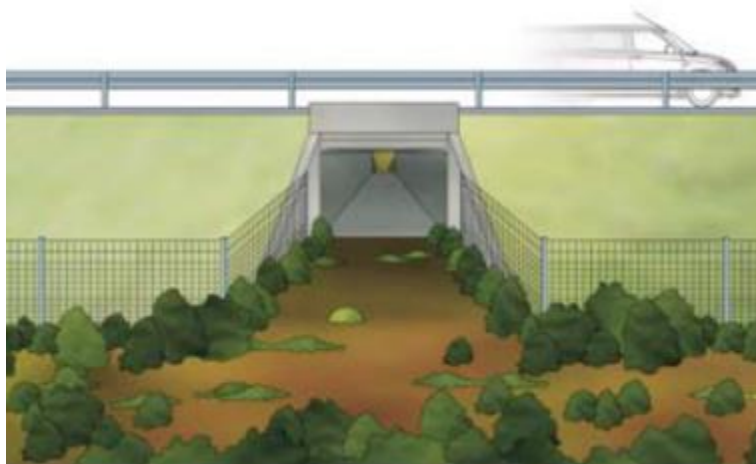
Figura 120. Ejemplo de paso inferior seco
