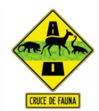
Figura 123. Dispositivo de prevención nacional para el cruce de fauna
