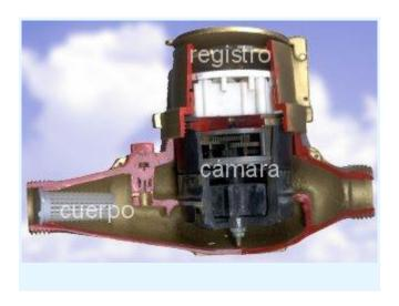
El principio de funcionamiento de un hidrómetro se basa en que el agua penetra en la cámara de medición produciéndose el movimiento de una turbina o un pistón (según el caso de lo que se pretenda medir, el volumen de agua que pasa o la velocidad con que lo hace) por el empuje de agua.
