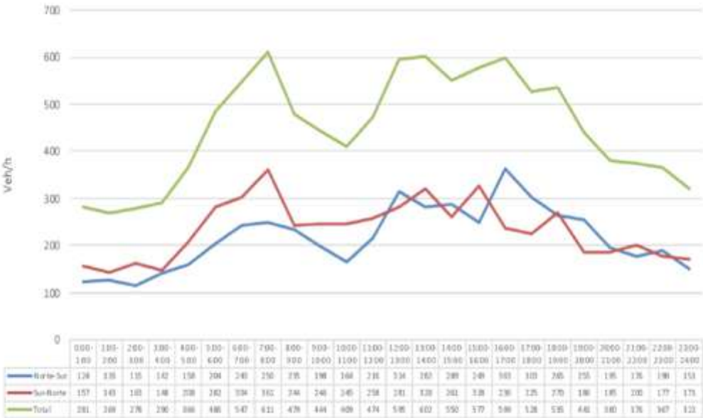
Figura 10. Perfiles de variación horaria del flujo vehicular: Estación 3
