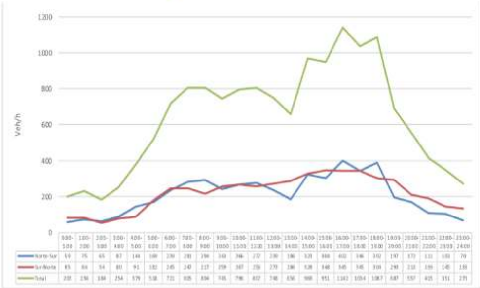
Figura 12. Perfiles de variación horaria del flujo vehicular: Estación 3
