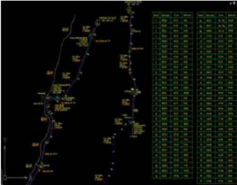
A su vez de manera paralela, de la **tercer etapa** se encuentra concluida la instalación de la tubería de conducción (18.5 km), saliendo de la naciente los negritos hasta el punto 101, sitio donde se estipula la construcción de un tanque de almacenamiento de 2000 m<sup>3</sup>.
